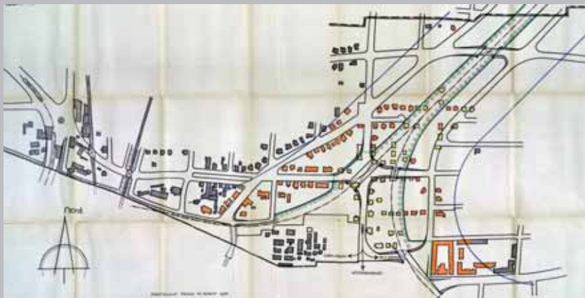
Plan Stadtbauamt Pasing, August 1935; Auswirkungen RB-Planung auf die Kolonien: hoher Gebäudeverlust, neue Ost-West-Straße Kolonie I-II zerstört Wensauerplatz, weite Bereiche vom Schallpegel der geplanten Güterlinien betroffen, neue Brücken und Tunnelbauwerke erforderlich Stadtbauamt München
