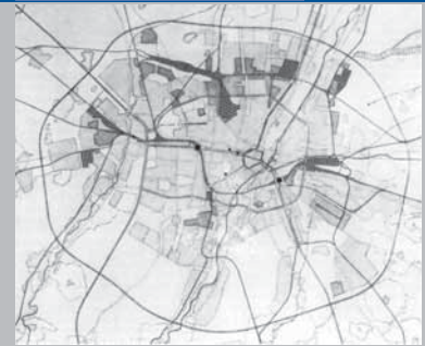
„Verkehrsplanung“ GBR 1940. Autobahnring im 10-km-Radius um München als Siedlungszone, ein Autobahzubringer mitten durch den Obermensing-„Durchblick“. Die neue Nordringgüterlinie ab Olching entlastet Pasing.
